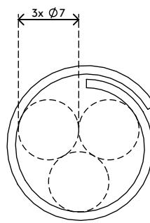
Addit Kabelschlucker ø15 mm / 3 m + Einzugshilfe 732
